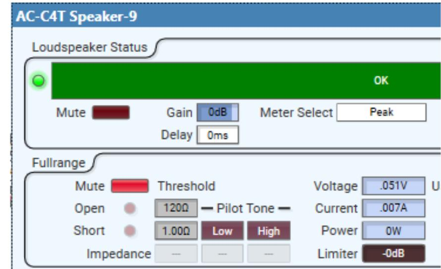
En amplificadores monitoreados de Q-Sys se puede medir la impedancia de la línea de altavoces:
